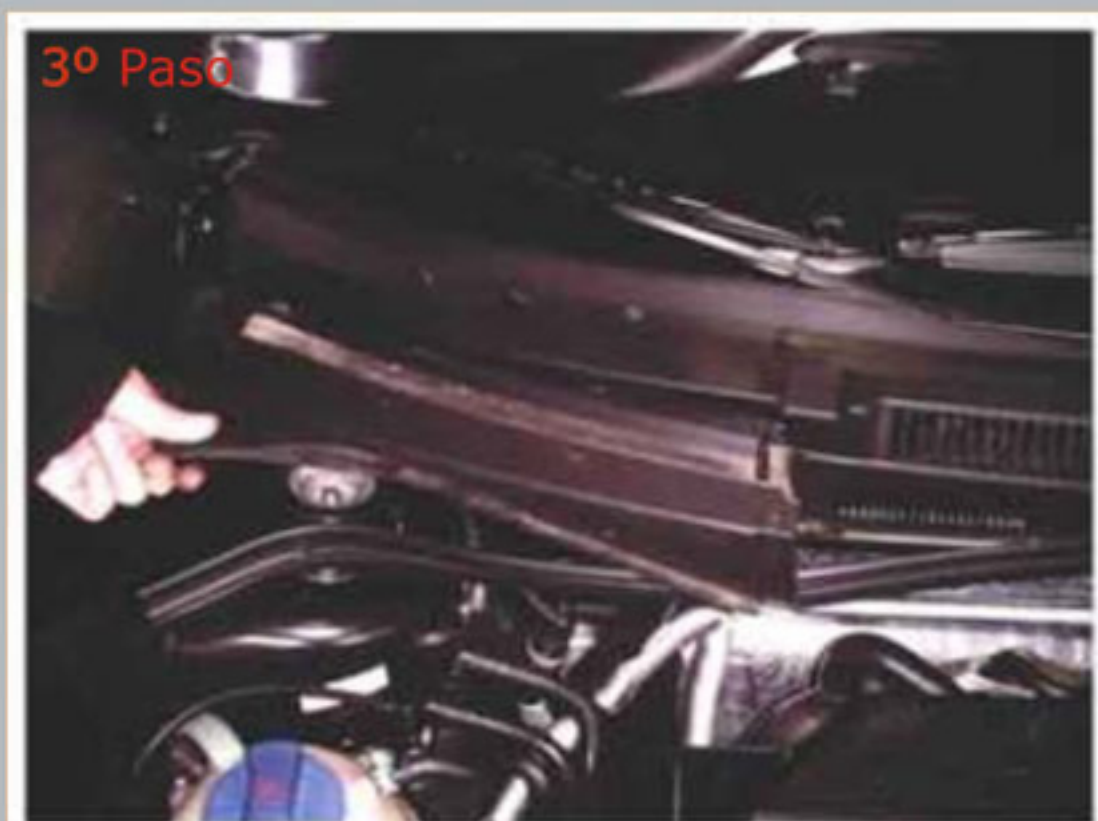
Retire la tapa, destrabe la moldura y cambie el filtro.
