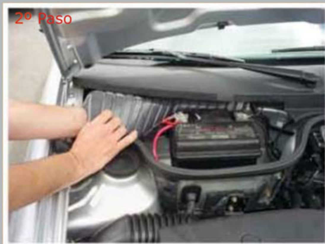
Levante la capa plástica para retirar el filtro.
