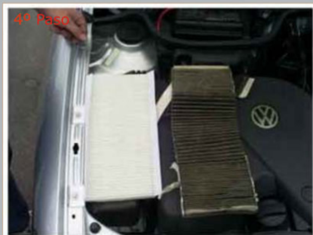
Coloque el filtro nuevo e invierta las etapas para colocarlo
