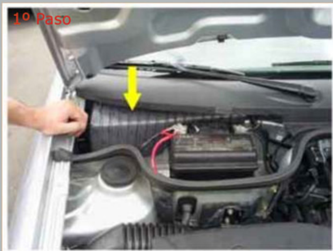
El filtro esta ubicado detrás del acabado indicado.
