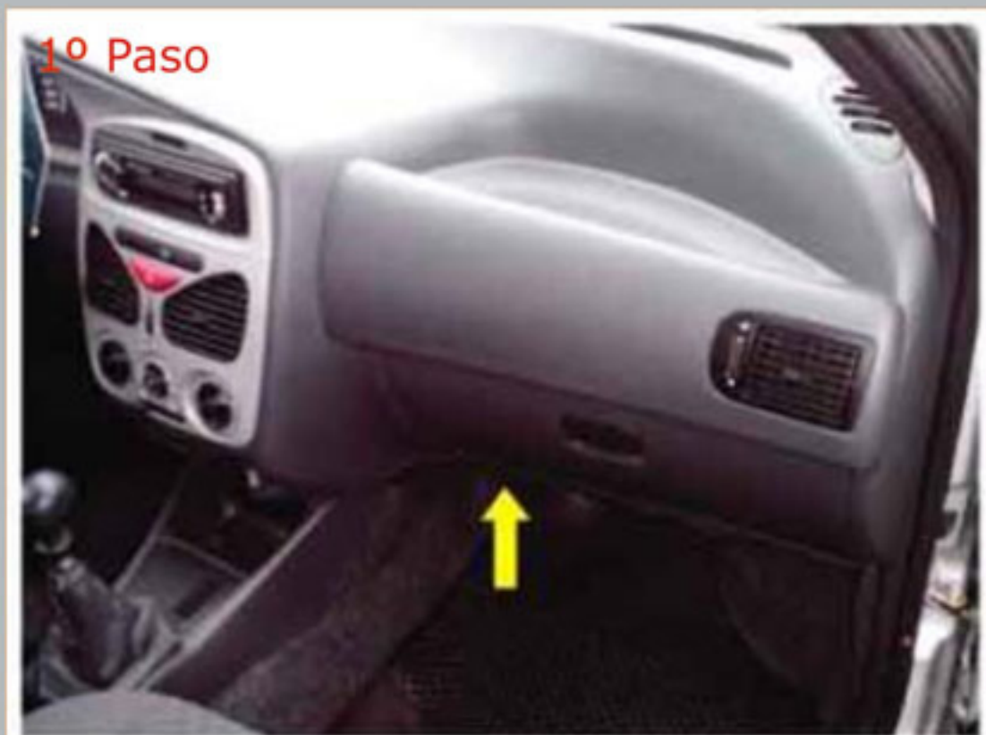
El filtro está ubicado detrás de la guantera a la izquierda.
