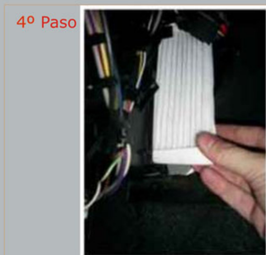
Cambie el filtro e invierta las etapas anteriores para colocarlo.
