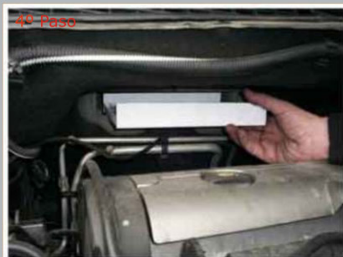
Cambie el filtro e invierta las etapas anteriores para colocarlo
