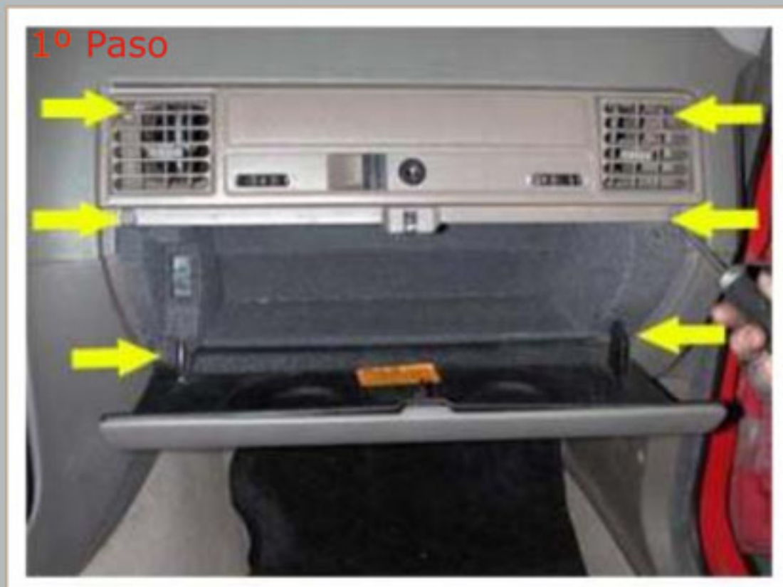
Abra la tapa de la guantera y retire los tornillos indicados.
