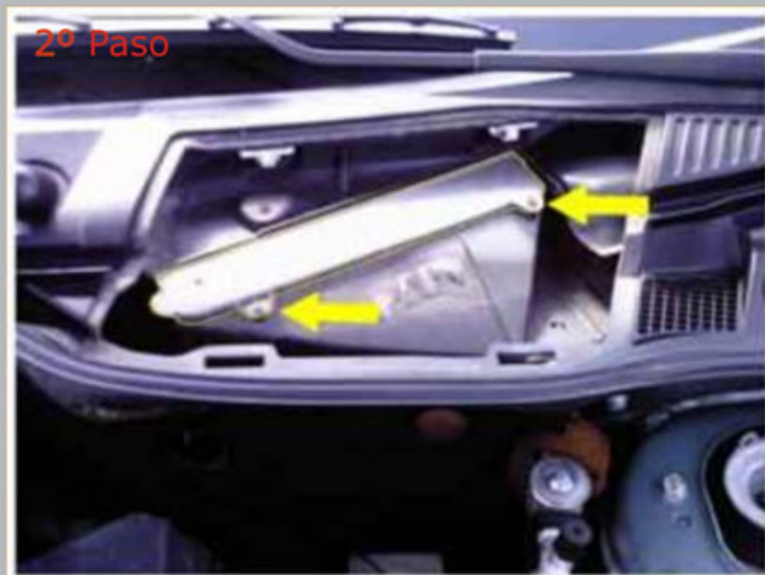
Suelte los tornillos indicados, retire la tapa y cambie el filtro.
