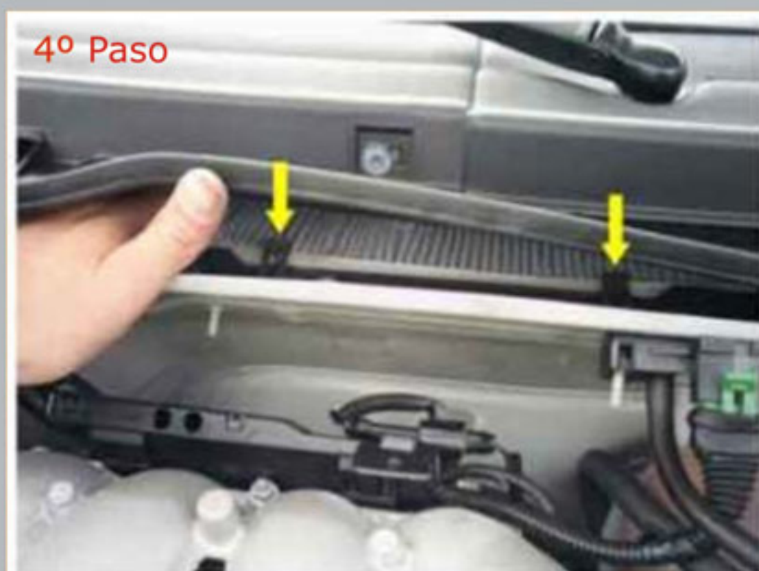
Levante la capa plástica, suelte las presillas y cambie el filtro.
