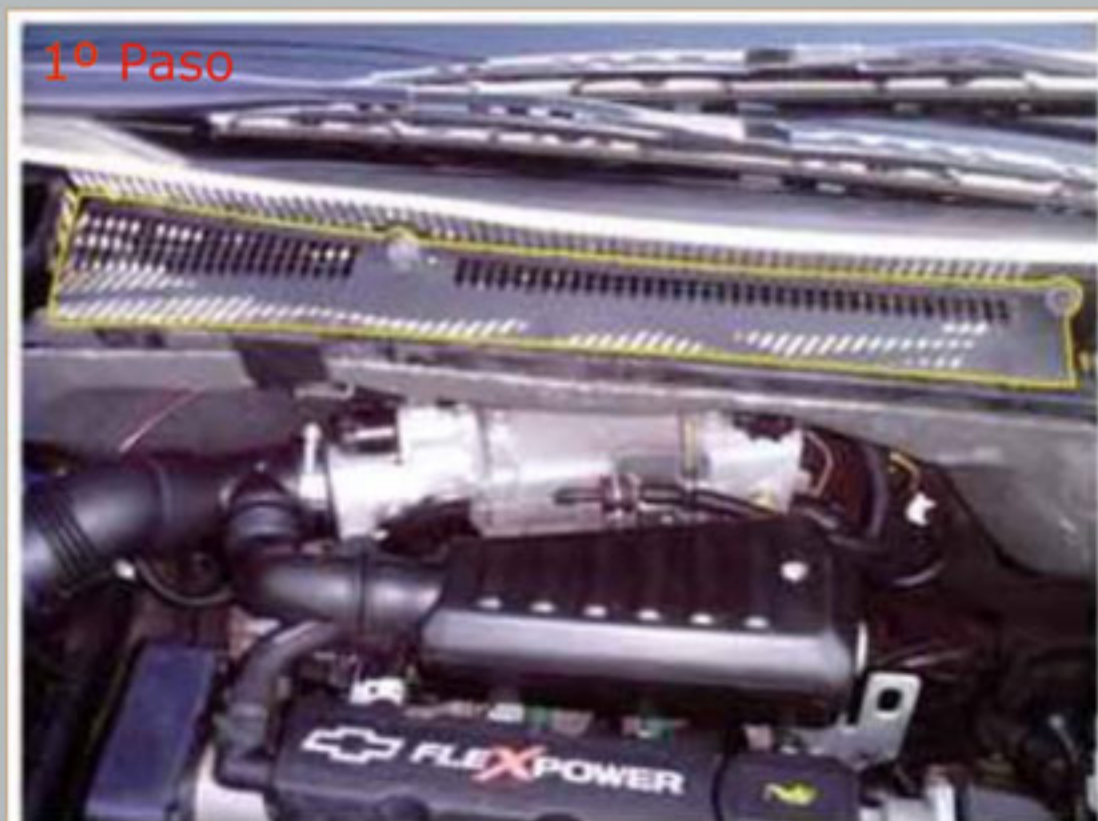
El filtro está ubicado debajo del acabado indicado.
